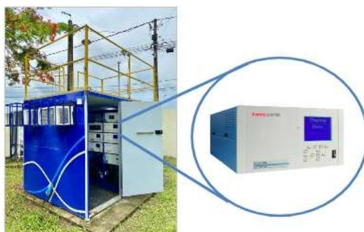
Figura 2. Estação Ipojuca e analisador de óxido de nitrogênio, Fonte: Site da CPRH-PE.
