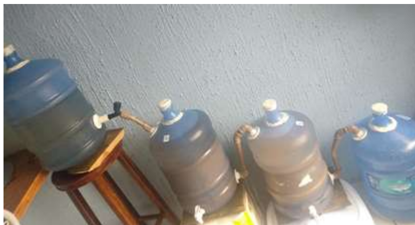
Figura 2. Configuração do sistema de filtração como uso de canos rígidos de PVC. Fonte: Autor 2024.
