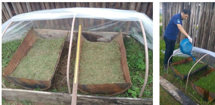
Figura 7 – Irrigação da gramínea com efluente (canteiro da esquerda) e irrigação com água de abastecimento público (canteiro da direita). Imagem do momento do plantio e após 60 dias. Fonte: Própria (2017)
