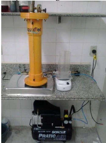
Figura 7. Sistema de flotação por ar dissolvido (FAD) de bancada utilizado nos experimentos de flotação de águas eutrofizadas. Fonte: Autoral dos pesquisadores.
