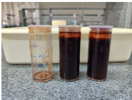
Figura 8. Coagulantes sintetizados a partir da reação de extratos vegetais com base de Mannich. Direita: Extrato 1 pelo uso de 0,5 ml de dietanolamina; Meio: Extrato 2 pelo uso de 2,0 ml de dietanolamina; Esquerda: Extrato 3 pelo uso de 6,0 ml de dietanolamina. Fonte: Autoral dos pesquisadores
