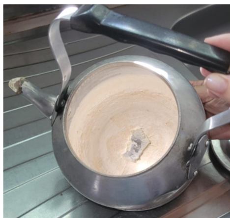
Figura 2: Chaleira calcificada após constante uso da água. Fonte: Autor do Trabalho
