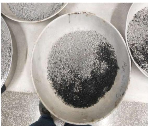
2 a: Mistura dos agregados com a borracha
