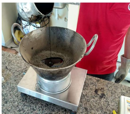
2 b: Pesagem dos agregados com o CAP
