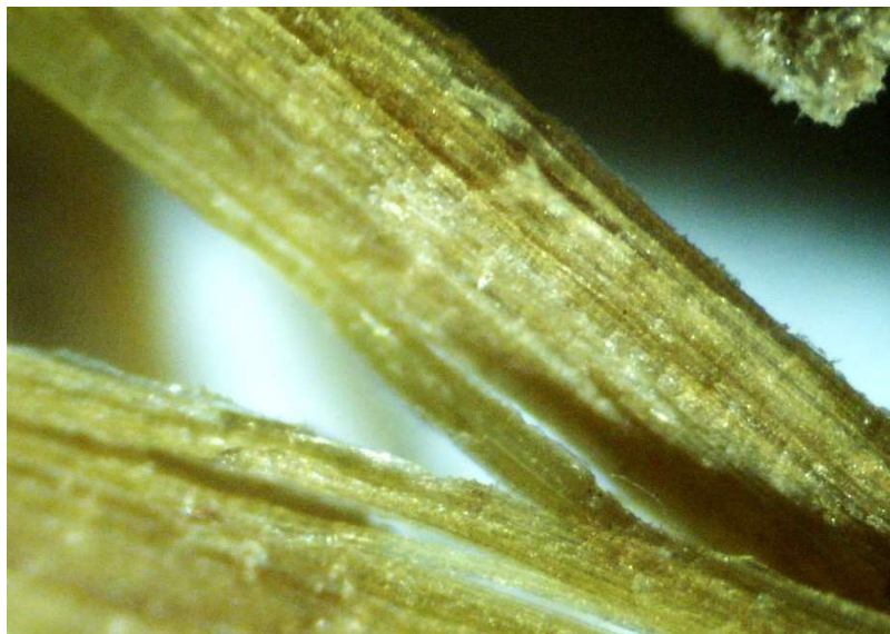
Figura 5: Imagem da Serragem de Bambu com zoom 4X na Lupa SLQ-M-003.
