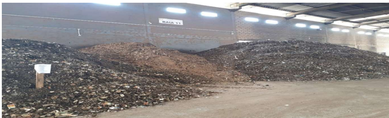
Figura 4: Combustível Derivado de Resíduos Sólidos pronto para expedição e queima. Fonte: Autores (2022).
