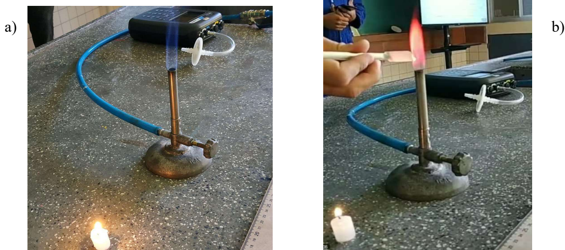
Figura 3 - (a) chama da mistura biogás + ar ; (b) chama da mistura biogás + ar + sais de lítio.
