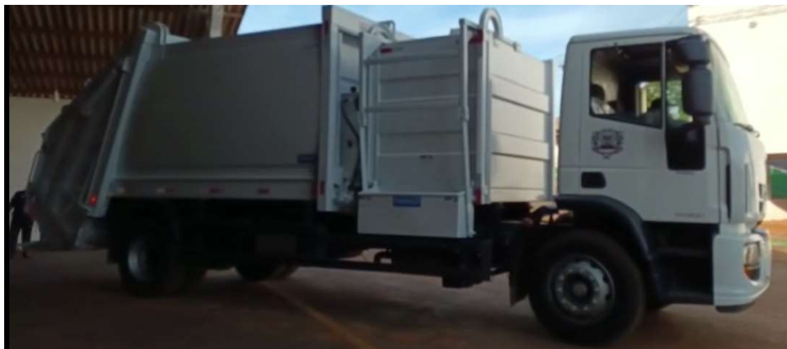
Figura 2: Foto do caminhão desenvolvido pela prefeitura de MCR para coleta seletiva de resíduos orgânicos. Fonte: Autores do Trabalho.
