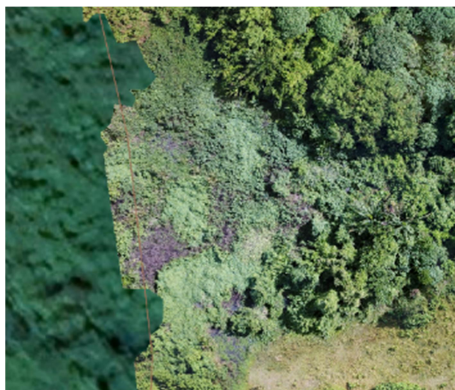
Figura 7: União de imagem de satélite com sobreposição de imagens de um ortofotomosaico junto a delimitação de cursos d'água. Fonte: Autores do Trabalho.
