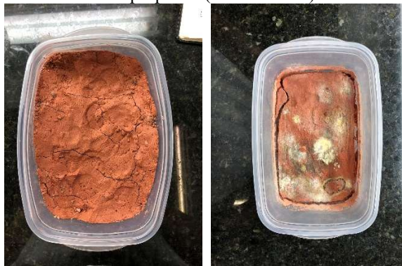
Figura 5 Testes de incorporação da semente em mistura de terra, água e cal (à esquerda) e apenas terra e água (à direita). Foto: Claudia Oliveira, 2020.
