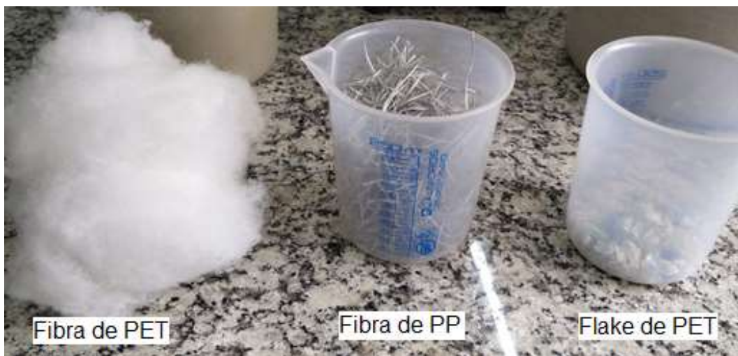
Figura 2: Materiais utilizados em adição às argamassas estudadas. Fonte: Autores do Trabalho.
