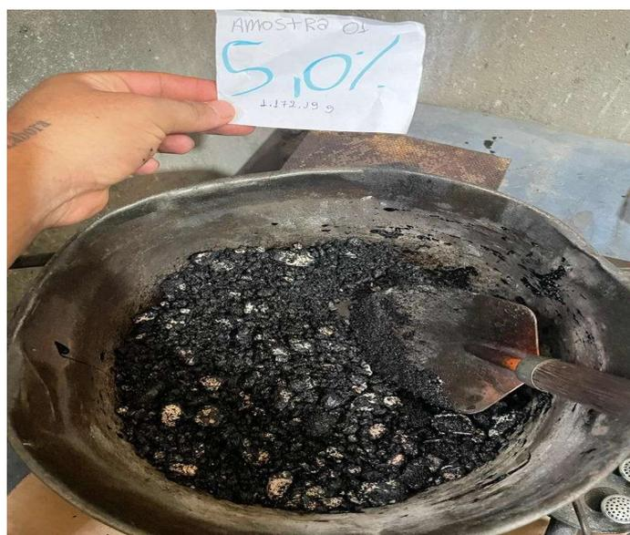
**Figura 2: Mistura e aquecimento dos materiais para compactação dos corpos de provas**
