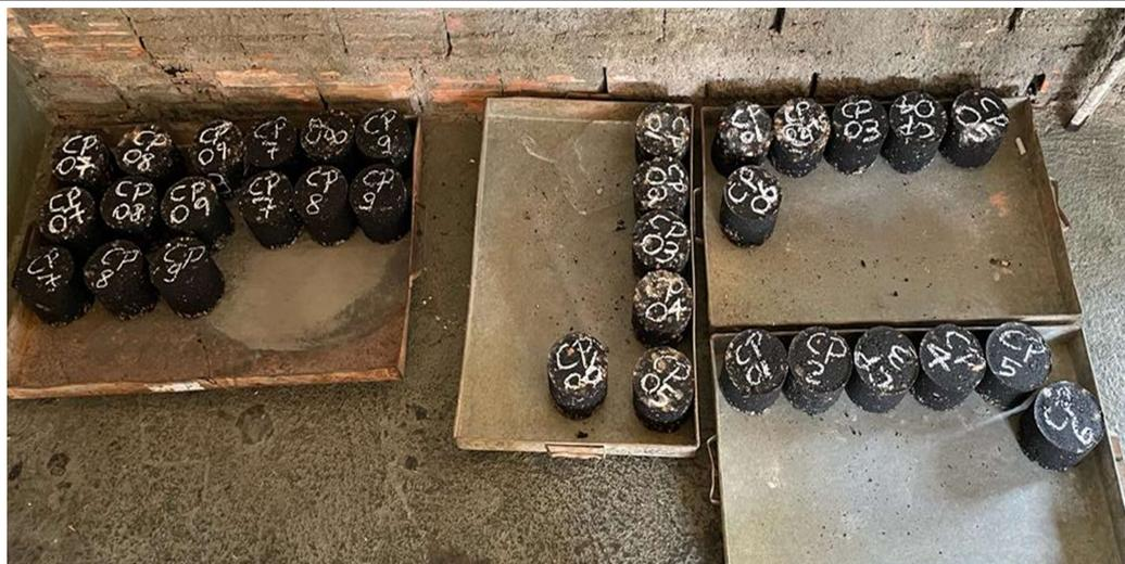
**Figura 3: Corpos-de-prova de CAUQ obtidos**
