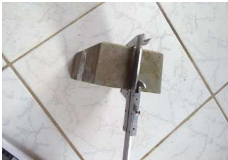
Figura 1: Avaliação dimensional dos pavers. Fonte: Autor do Trabalho.
