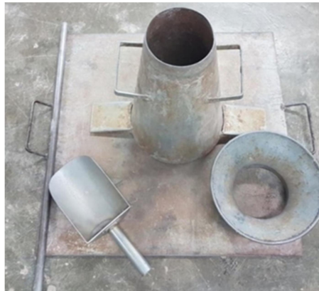
Figura 4: Slump test usado para o ensaio de consistência. Fonte: Autores, 2020.
