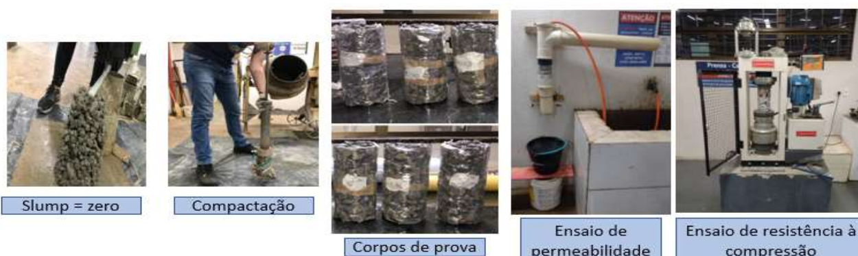
Figura 2 – Preparo dos CP's para os ensaios de permeabilidade e resistência à compressão. Fonte: Autores, 2023.
