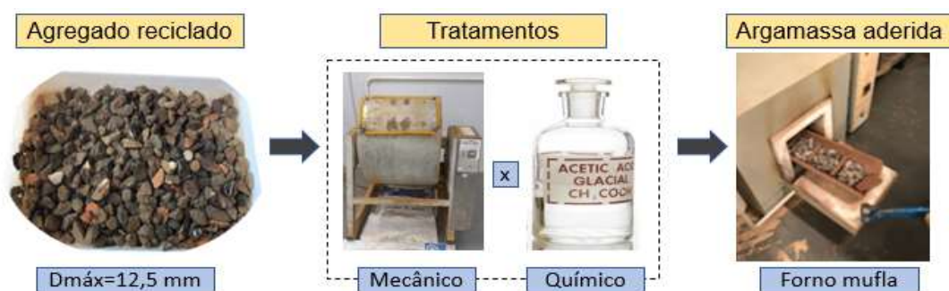
Figura 1 – Estudo dos tratamentos no agregado reciclado. Fonte: Autores, 2023.
