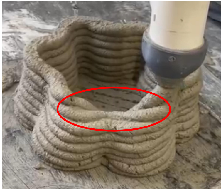
Figura 6: Traço F – colapso local no corpo de prova.
