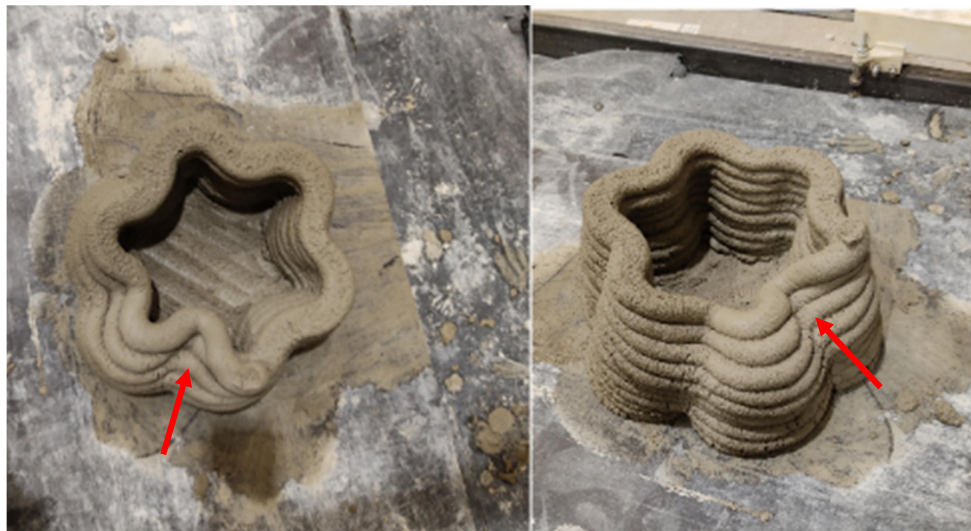
Figura 7: Traço C - colapso local no corpo de prova.
