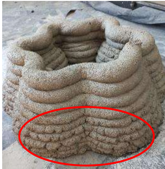
Figura 10: Traço N - plastificação da argamassa, gerando “rachaduras” na base.
