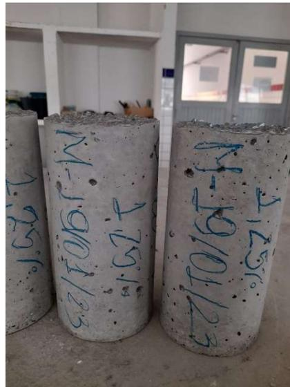
Figura 4: Corpos de prova com 1,25% de adição de EPS. Fonte: Autor do trabalho.
