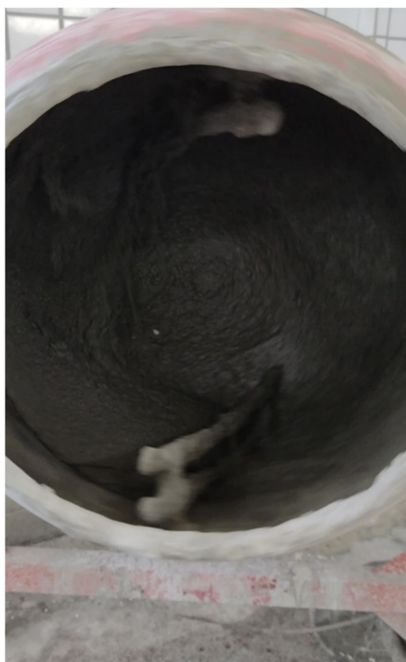
Figura 3: Produção do concreto com 2% de RFV. Fonte: Autor do trabalho, 2022.
