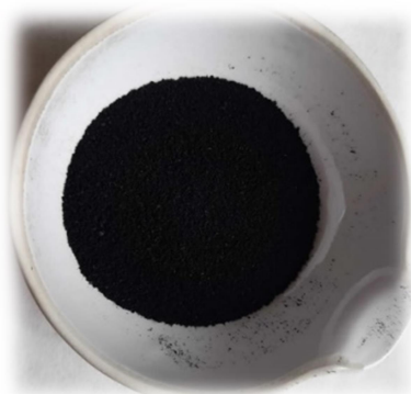
Figura 1: Carvão ativado produzido a partir da carbonização da borra de café com cloreto de zinco
