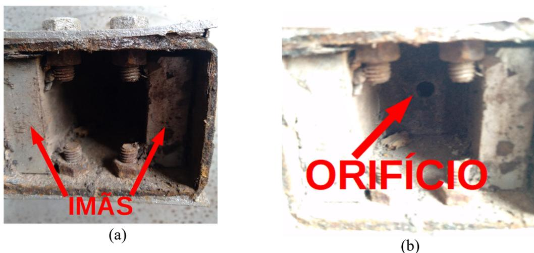
**Figura 4 – Foto em detalhe das entradas de ar no protótipo para “decomposição magnética”. A foto a) mostra a montagem da dupla dos ímãs em cada entrada. Na foto b) Detalhe de orifício de entrada de ar. Fonte: Autores do Trabalho.**
