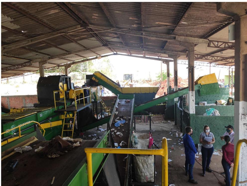
**Figura 3: Foto panorâmica da planta experimental para triagem mecanizada de resíduos sólidos urbanos. Fonte: Autores do Trabalho.**
