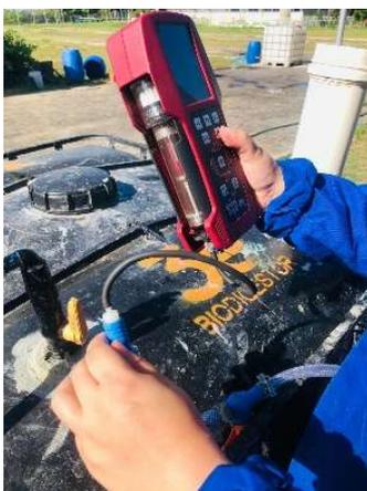
**Figura 5- Realização de testes com analisador Optima7. Fonte: Autor do Trabalho.**
