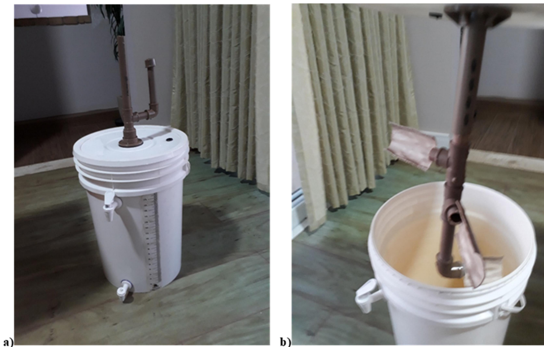
Figura 1: a) Reator com o alimentador/misturador na tampa b) Detalhe do alimentador/misturador Fonte: Autor do Trabalho.
