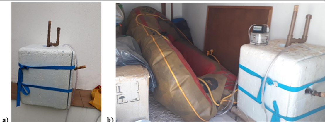
Figura 2: a) Reator inserido em caixa de isopor. b) Conexão do reator com o micromedidor de vazão e o reservatório de biogás
