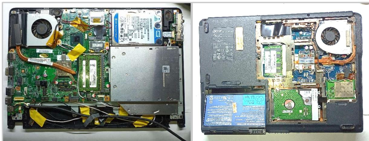
Figura 3: Componentes de notebook durante o processo de desmontagem. As figuras fazem parte do manual de desmonte de eletrônicos. Fonte: Autor do Trabalho.
