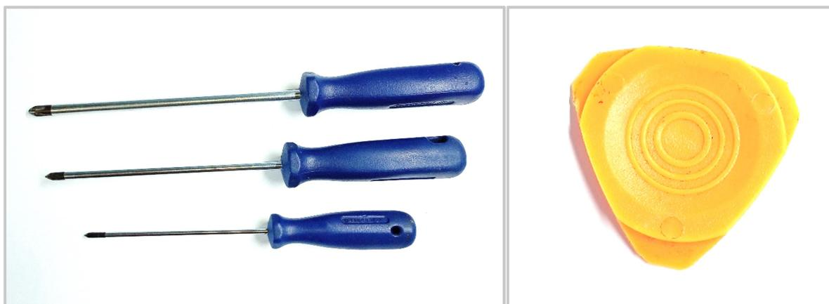
Figura 2: Parte do manual - Ferramentas para desmontar. Principais ferramentas utilizadas no desmonte de eletroeletrônicos. Fonte: Autor do Trabalho.
