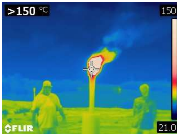
Figura 4: Fotografia termográfica em espectro infravermelho da chama de biogás no aterro sanitário em Marechal Cândido Rondon/PR. Fonte: Autores do Trabalho.
