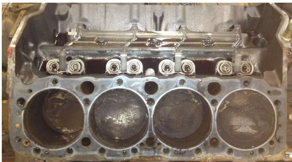
Figura 1: Fotografia da vista superior parcial do bloco do motor Vortec GM, quando da verificação para envio para manutenção e retífica. Fonte: Autores do Trabalho.
