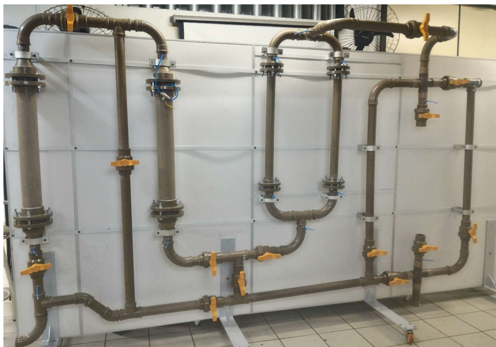
Figura 6: Fotografia do painel móvel para filtragem de biogás utilizando recheio intercambiável. Fonte: Autores do Trabalho.
