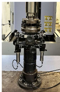
Figura 5: Ensaio de compressão uniaxial. Fonte: Autor do Trabalho.
