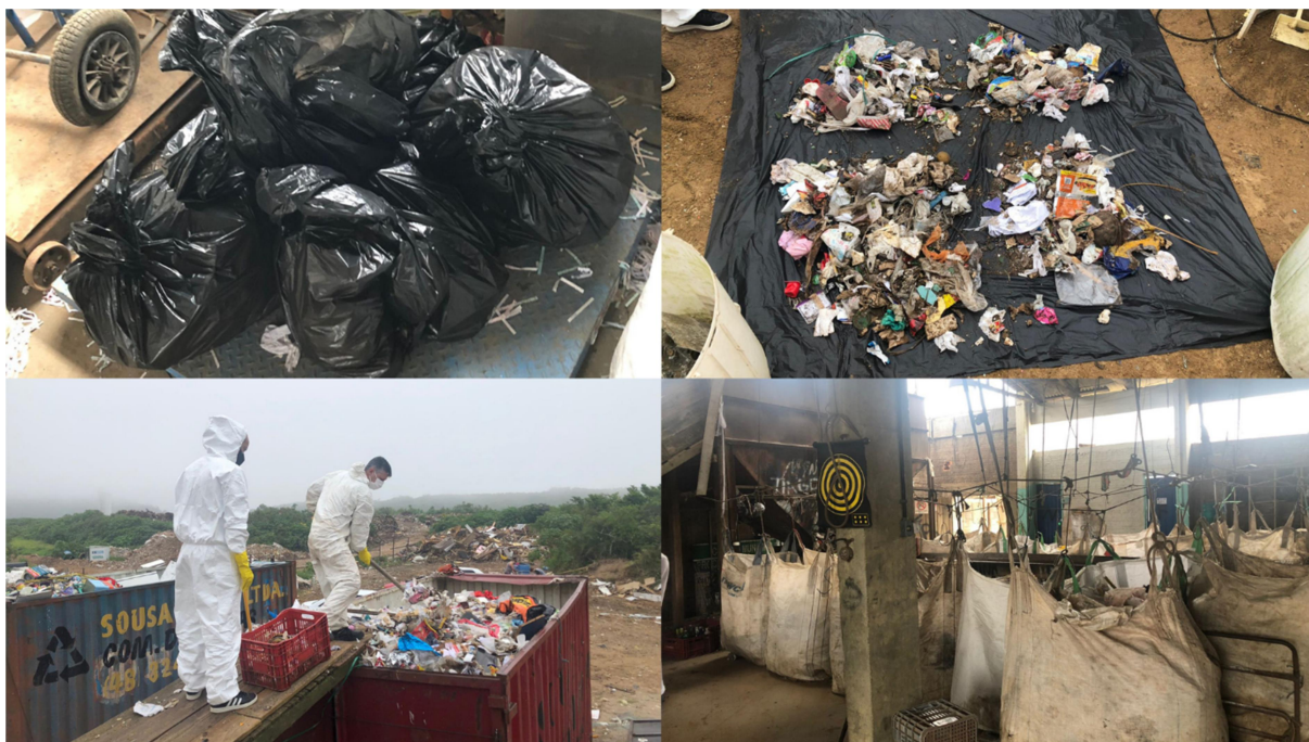
Figura 2: Coleta de amostras de rejeitos da triagem de RSU de Imbituba/SC. Fonte: Autores do Trabalho.
