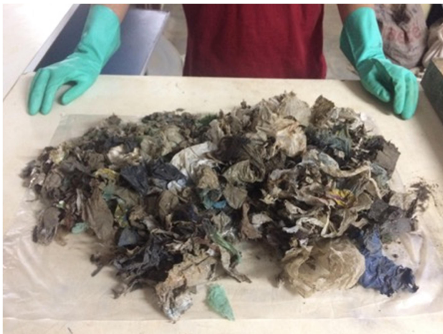
Figura 3: (b) Material retido na peneira de 8 mm. Fonte: Autores.
