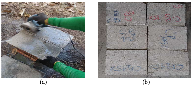
Figura 3: Placas para ensaio impacto: (a) Cortes das placas, (b) placas com teor 15% de borracha cortadas e identificadas Fonte: Santos, R.M (2018).
