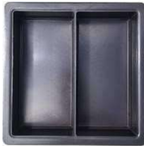
Figura 1: Fôrmas retangulares em PVC utilizada nas moldagens. Fonte: Autor do Trabalho.
