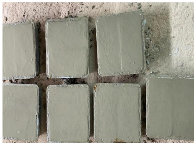
Figura 01: Peças com acabamento da face superior. Fonte: Autor do Trabalho (2022).
