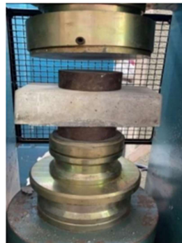
Figura 03: Ensaio de resistência à compressão. Fonte: Autor do Trabalho (2022).
