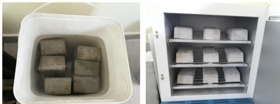
Figura 04: Determinação da absorção de água dos pavers. Fonte: Autor do Trabalho (2022).
