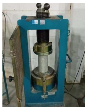
Figura 6. Imagem representativa durante o teste de resistência dos corpos de prova
