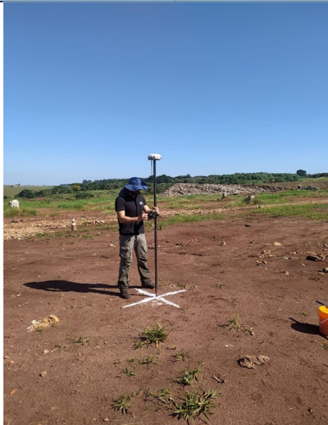
Figura 1- Coleta de pontos de controle com GNSS - RTK. Fonte: Autor do trabalho.
