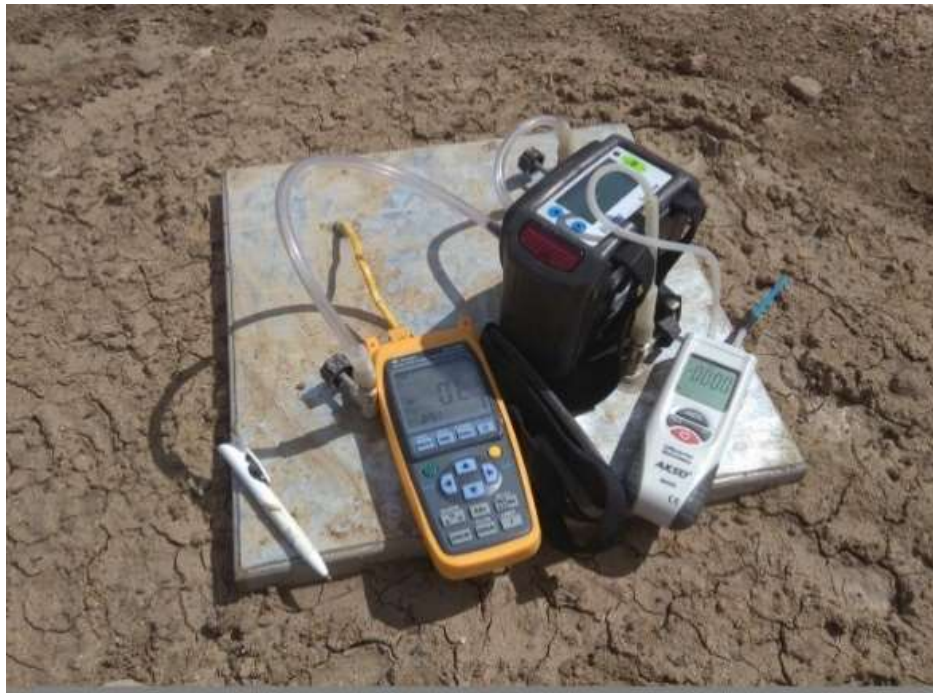
Figura 2: Placa de fluxo instalada para realização de ensaios nesta pesquisa. Fonte: Autor do Trabalho.
