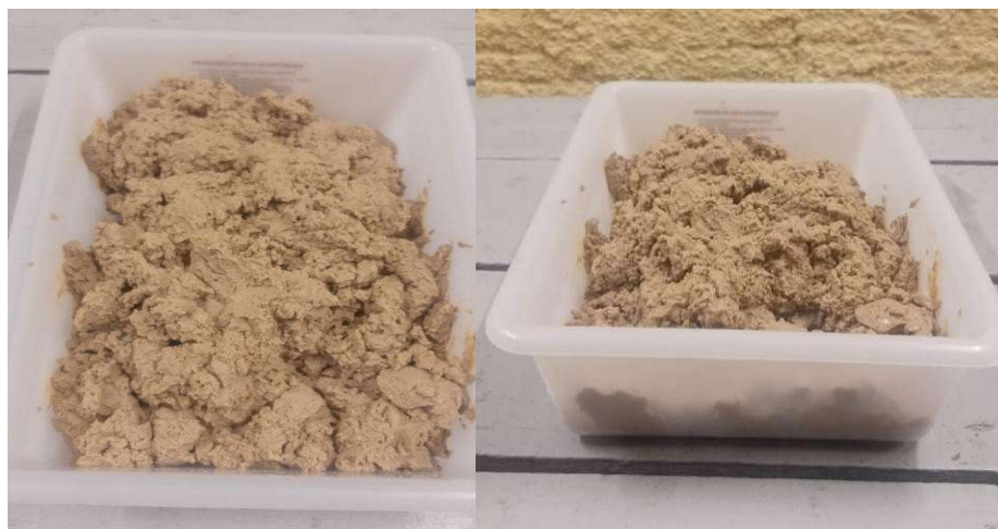
Figura 2: Secagem do lodo de ETE
